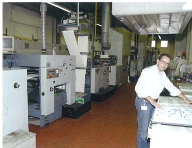
Links: Roland Arndt (Prokurist Leitung Technik, Qualitätsmanagement) weiß, wovon er spricht, wenn er „die Lizenz zum Banknotendruck“ meint: Die Gelddruckmaschine von Goebel (Darmstadt) bei SSP Ident ist auch mit Stahlstichtiefdruckwerk (Intaglio), das für Banknoten benötigt wird, ausgestattet. Rechts: Prüfung des Wasserzeichens und weiterer Sicherheitselemente auf einem Bogen mit Steuerbänderolen.
