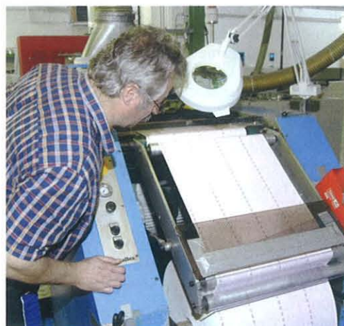
Ihm entgeht nichts: Dem strengen Blick des Sicherheitsdruckers, der sich hier vom richtigen Stand der holografischen Sicherheitselemente auf einer Wertcoupon-Papierbahn überzeugt.
