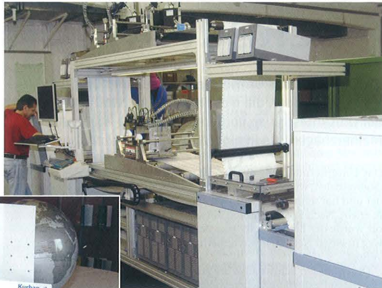
Links: Das Spektrum an Wertpapier- und Sicherheitsdruck-Produkten, die SSP Ident produziert, ist breit gefächert. Abbildung oben: Eine Verarbeitungsstraße für Endlosbahnen mit Sicherheitselementen (zum Beispiel Hologramm-Applikation, Micro-Perforation, Prägung).
